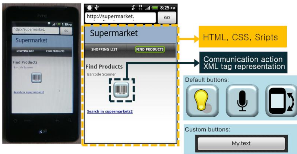
Figura 9.20 - En la captura se muestran los formatos de botones que se asocian a las etiquetas XML de contexto.
