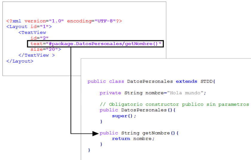
Figura 7.12 - La interfaz gráfica hace referencia a un método público contenido en el código ejecutable.
