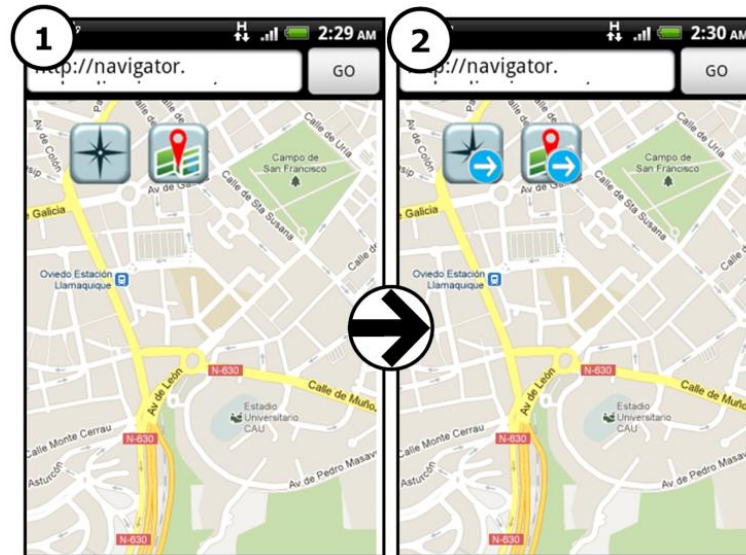
Figura 10.8 - En la primera captura de pantalla el usuario no ha dado su permiso para la captura y envío de la información de contexto. En la segunda captura el usuario ha pulsado sobre los botones asociados a las etiquetas XML de contexto, iniciando así la ejecución de las tareas programadas.
