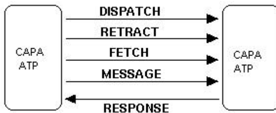
Figura 8.5.3.2 - El protocolo de transferencia ATP
