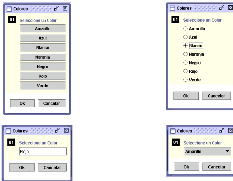
Figura 60. Representación de los cuatro posibles widgets candidatos a satisfacer los requisitos de interacción del segundo objeto incluido en el documento ACML del Código 30 (consultar versión en color en el capítulo 24: Imágenes en Color , p. 445).
