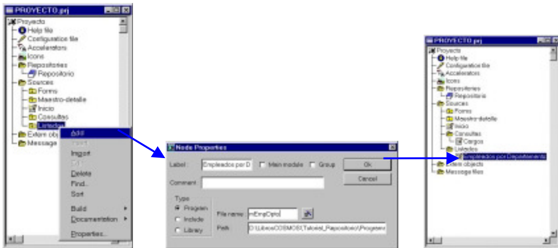
Figura 8.4. Añadir el nuevo módulo.
